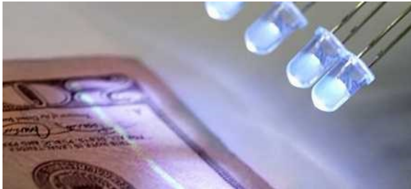
Anti-vervalsingskenmerken in een biljet van 20 dollar onthuld door een 400nm UVA-LED.
